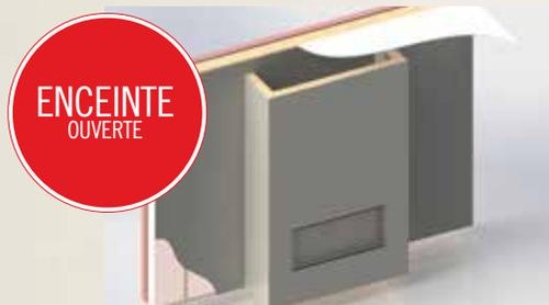
Le dessus s'arrêtant tout juste avant le plafond, l'air chaud qui monte peut s'échapper librement du haut de l'enceinte pour se répandre dans la pièce.
